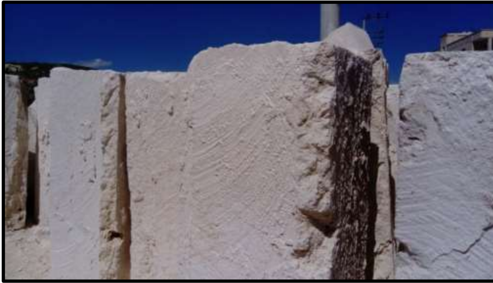
Şekil 7: Çalışma sahasındaki ocaktan çıkarılmış kalker taşı.
